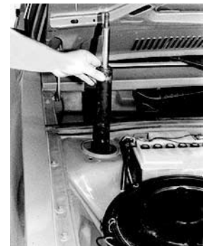
Stötdämparinsats byts utan att fjäderben demonteras t.ex. Audi 100
