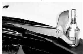
Armvdragning med tryckspindel.
