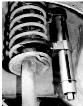
Fjäder spänns på fordon.
