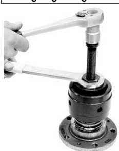
Avdragning av lagerbana
