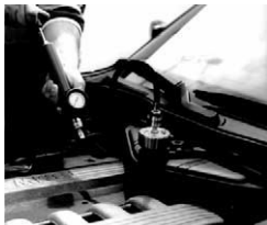
Direkt testning av kylsystem
