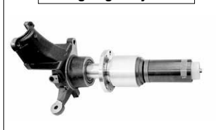
Idragning av hjulnav
