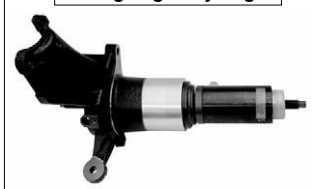
Idragning av hjulnav
