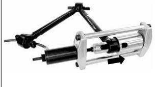
Bakre stabilisatorlager demontering
