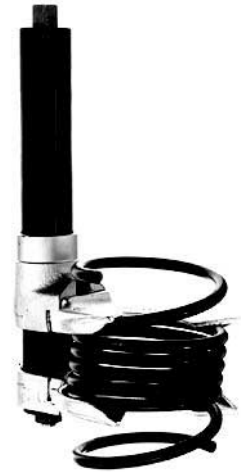
Fjäder spännt parallellt i botten.
