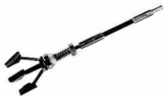
Rengöring av bromscaliper cylinder
