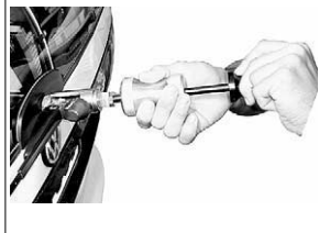
Armvdragning m. slagavdragare.
