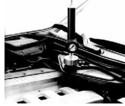
Indirekt testning av kylsystem
