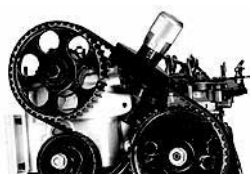
Mätning av kamremsspänning.
