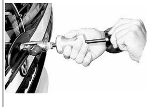
Armvadragning m. slagavdragare.
